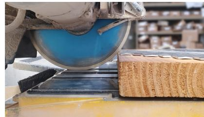
Recomendamos usar una pieza de madera contrachapada o 2x12 con un canal delgado cortado a través de ella para permitir que pase la hoja de sierra para baldosas, pero para evitar que las piezas se doblen durante el corte.
